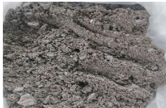
Рис. 1. Отвалы золошлаков гидроудаления Ангренской ТЭС (а), проба золошлаковых отходов гидроудаления (б)
